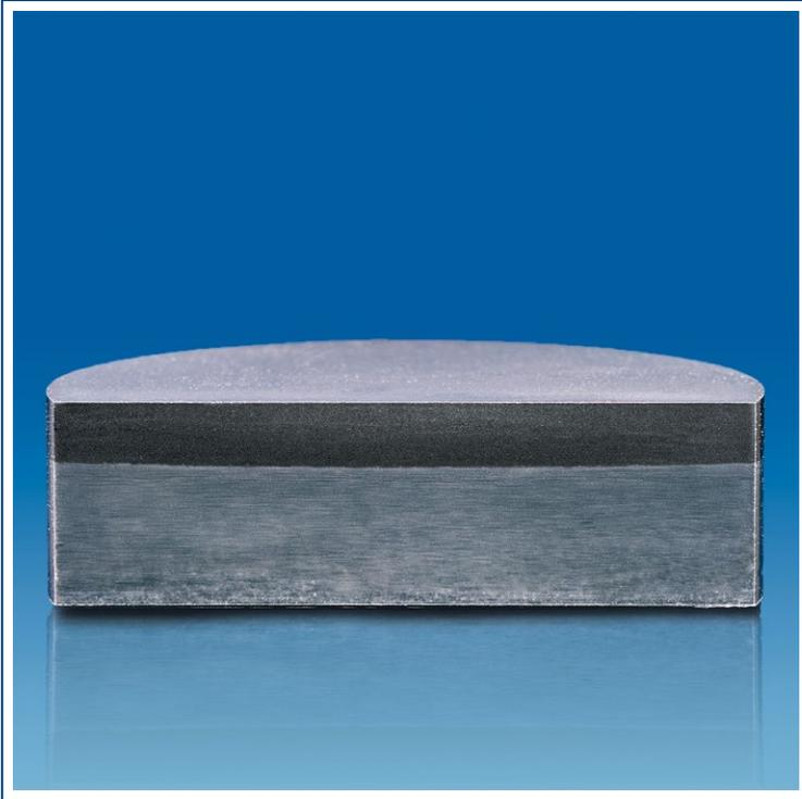
PKD-Hartmetall-Verbund: Ein verschleißfester Konstruktionswerkstoff
